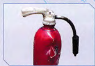
加熱部が局部的に膨張～ 溶融/火に接触したところ のみ損傷
